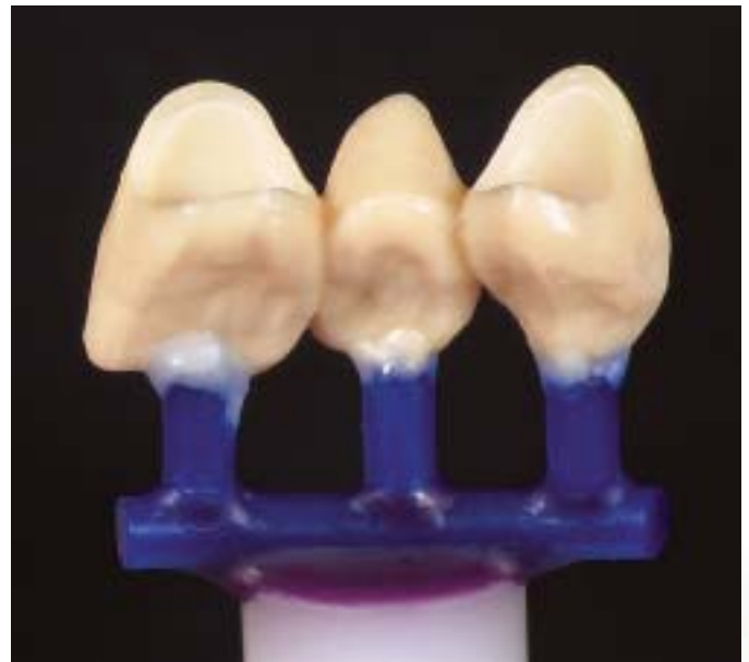
Abb. 17 Hier sieht man die angestiftete und mit einem Versorgungsbalken versehene Brücke – fertig zum Einbetten und Pressen.
