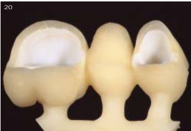
Abb. 18 Das Einbetten und Pressen erfolgt nach den bekannten Parametern beziehungsweise nach den Herstellerangaben.
